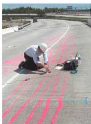
Prueba para conocer la calidad de la inyección de grout en ductos de postensado localizados por radar de penetración.
